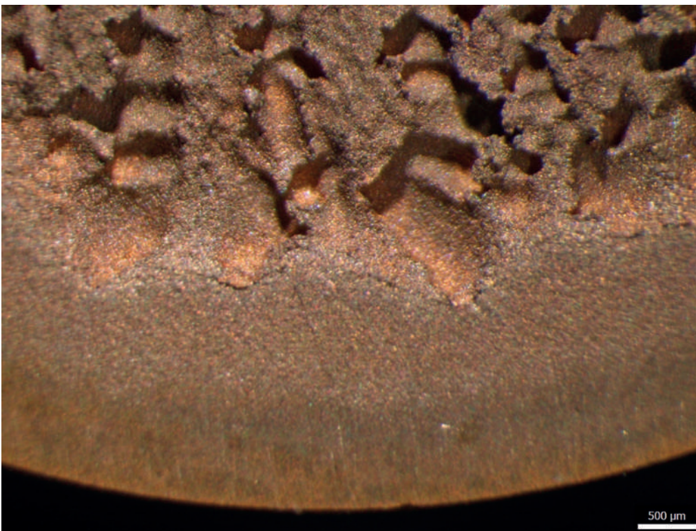
Fig. 23: Vue détaillée du décapage de matière sur la plaque d'essai
