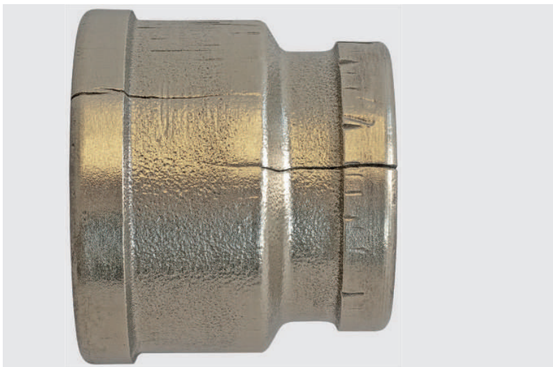
Fig. 19: Dommages que la corrosion fissurante sous tension a causés sur un raccord fileté
