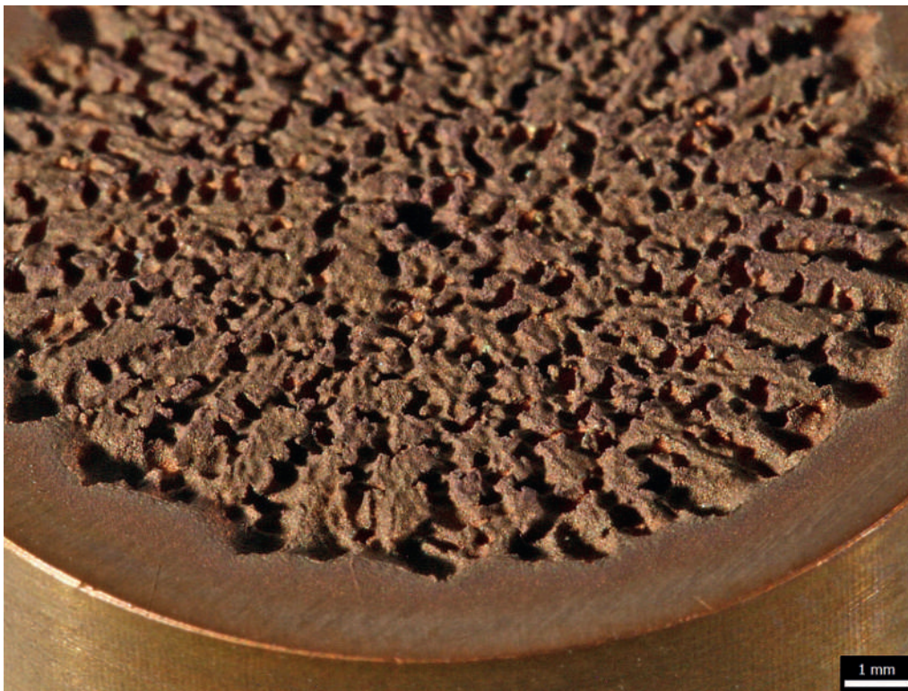
Fig. 22: Corrosion par cavitation sur une plaque d'essai en bronze sans plomb, sous l'action d'une sonotrode à ultrasons
