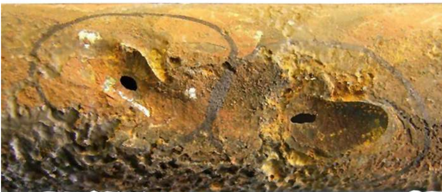
Fig. 8: Dommages par corrosion par hydrogène sur un tuyau en acier, provoqués par de l'acide sulfurique
