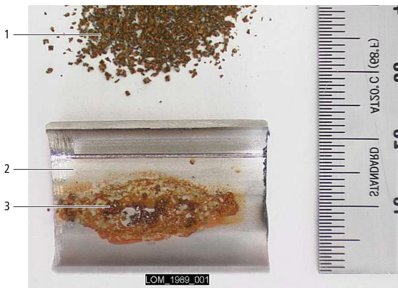
Fig. 38: Copeaux métalliques corrodés dans un tuyau en acier inoxydable
