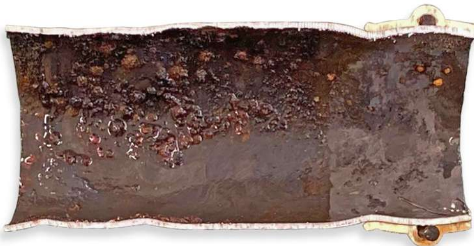
Fig. 6: Dommages causés par la corrosion par oxygène à l'intérieur d'un tuyau en acier
