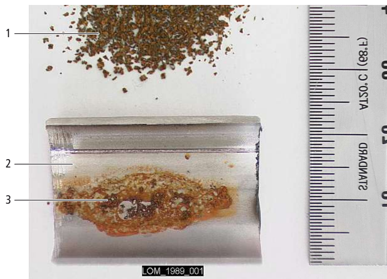
Fig. 45: Copeaux métalliques corrodés dans un tuyau en acier inoxydable
