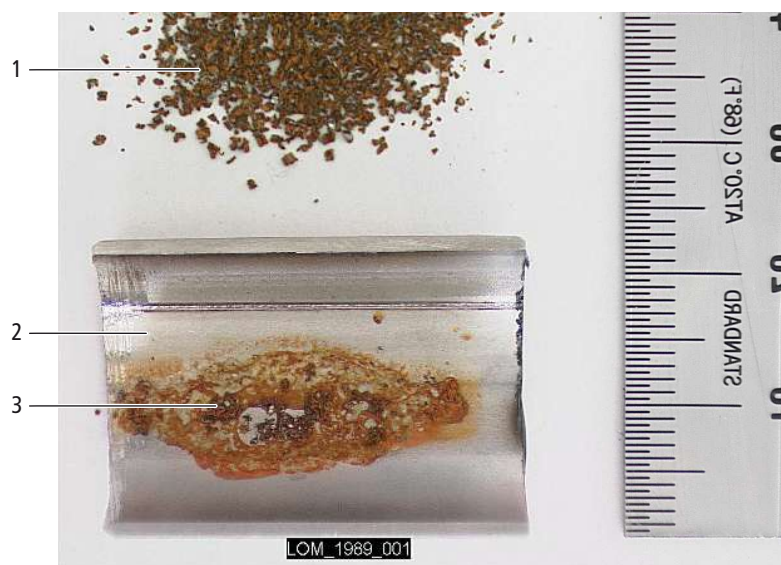
Fig. 45: Copeaux métalliques corrodés dans un tuyau en acier inoxydable
