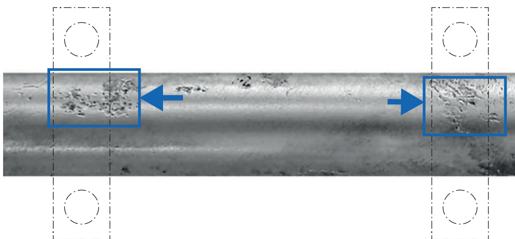
Fig. 10: Dommages par corrosion bimétallique causés sur un tuyau métallique du fait de colliers inadéquats
