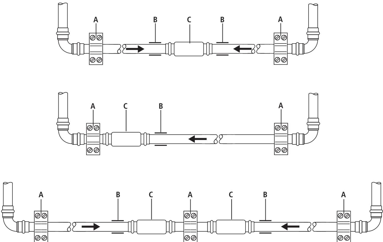
Abb. 17: Montagebeispiele Längenskompensator
