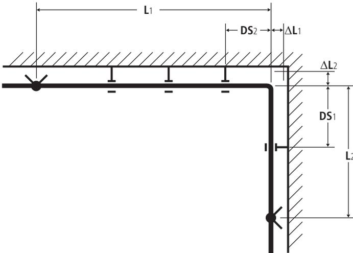
Abb. 6: L-Bogen-Dehnungsausgleicher
