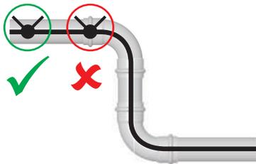
Auf Pressfittings dürfen keine Fixpunkte montiert werden.
