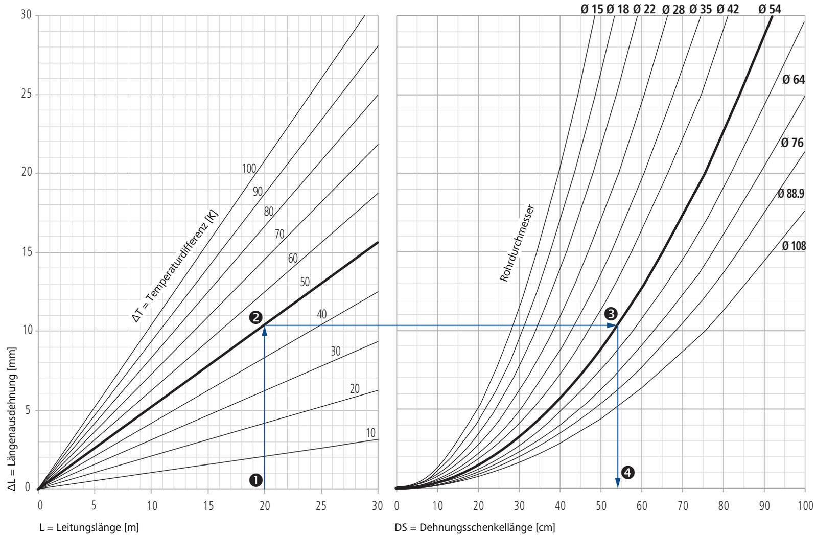
Abb. 12: Diagramm zur Ermittlung der Längenausdehnung  $\Delta L$  und Dehnungsschenkellänge  $DS$  für den U-Bogen für Optipress 1.4521
