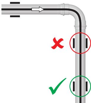
Gleitende Rohrführungen müssen so gesetzt werden, dass sie während des Betriebs nicht ungewollt zu Fixpunkten werden.
