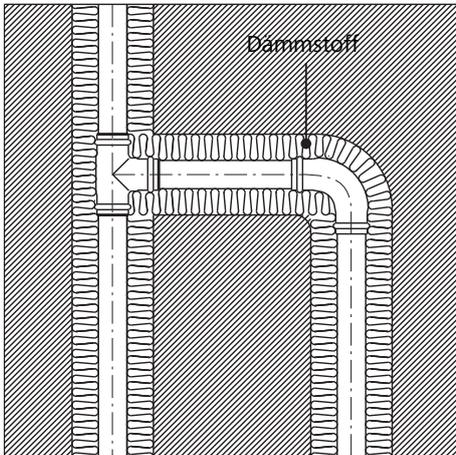
Abb. 3: Unterputz verlegte Rohre
