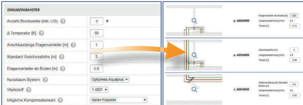
Abb. 20: Nussbaum Planungstool für vertikale Längenausdehnung
