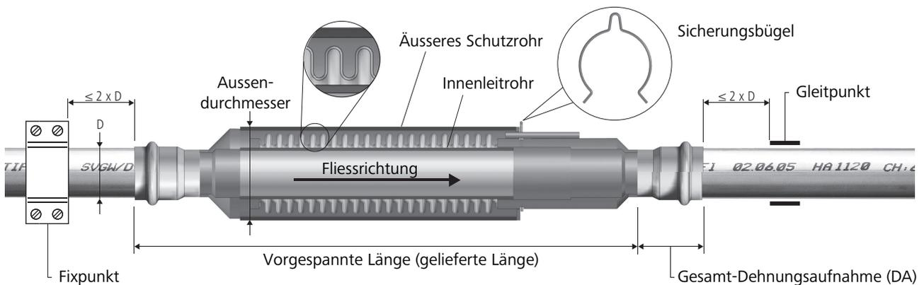
Abb. 16: Längenkompensator
