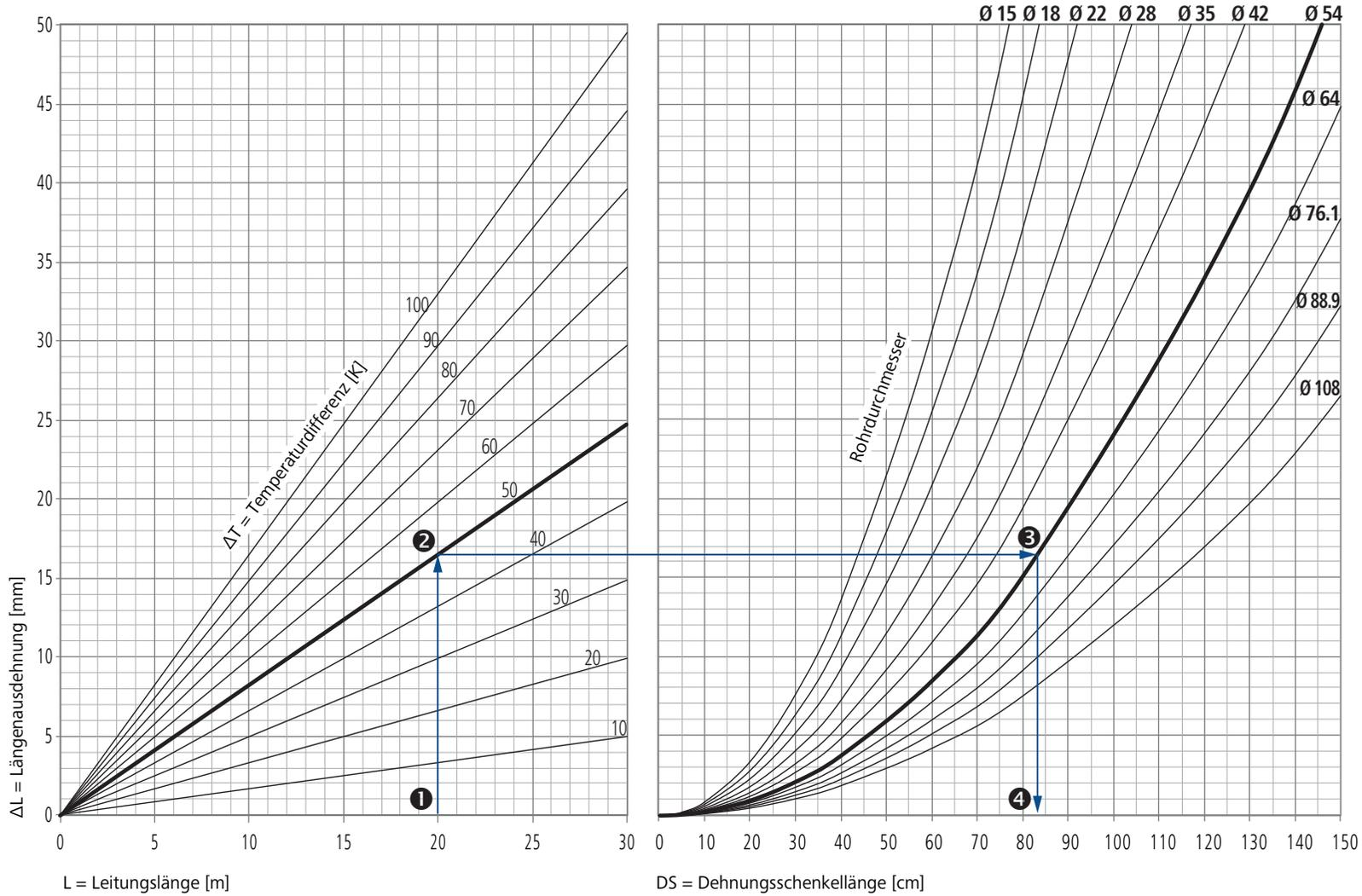
Abb. 13: Diagramm zur Ermittlung der Längenausdehnung  $\Delta L$  und Dehnungsschenkellänge  $DS$  für den U-Bogen für Optipress 1.4401/1.4404
