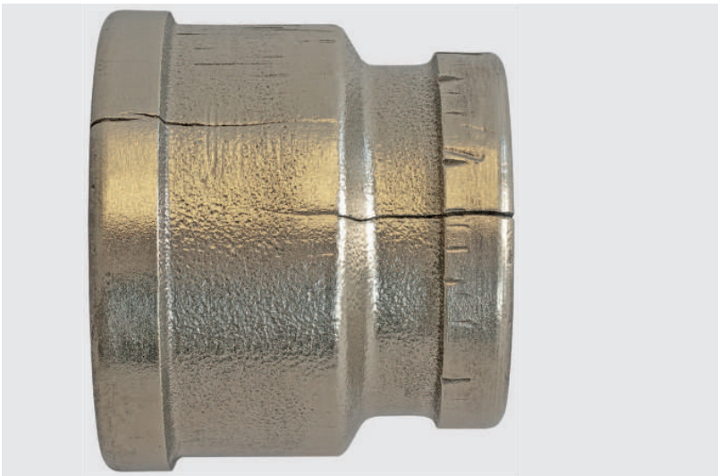
Abb. 19: Schadenbild Spannungsrisskorrosion an einem Schraubfitting
