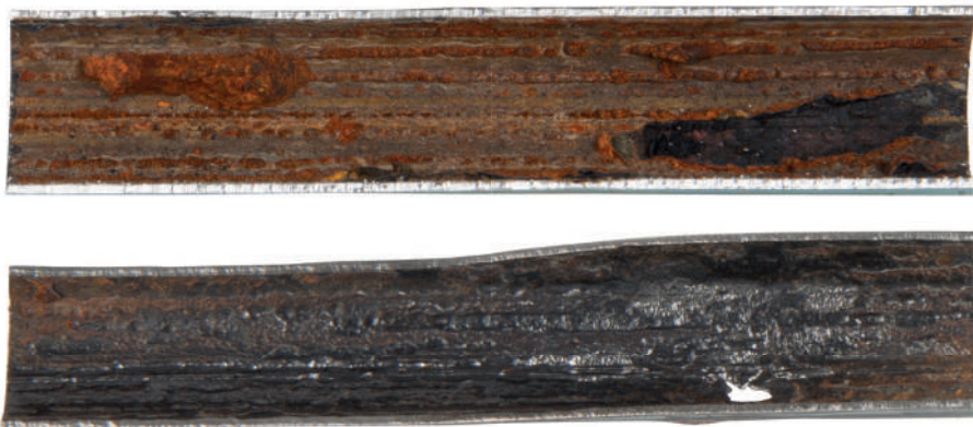
Abb. 13: Schadenbild Flächenskorrosion an einem Rohr aus Kohlenstoff-Stahl. Bild oben: Ansicht des Rohrs mit den Korrosionsprodukten. Bild unten: Das von den Korrosionsprodukten gereinigte Rohr
