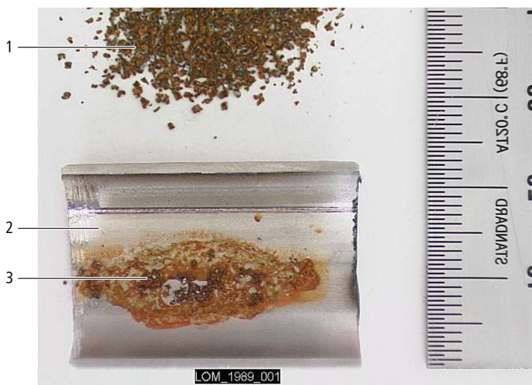
Abb. 45: Korrosion von Metallspänen in einem Edelstahlrohr
