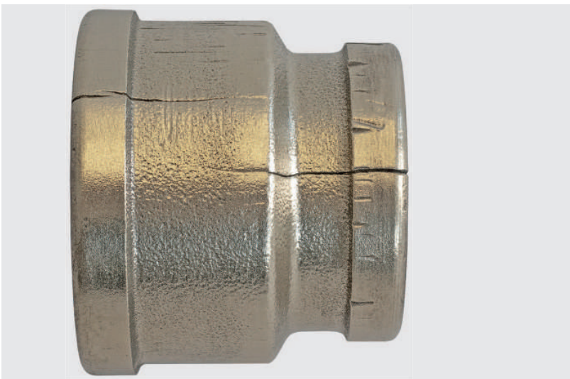
Abb. 19: Schadenbild Spannungsrisskorrosion an einem Schraubfitting
