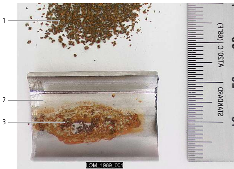
Abb. 45: Korrosion von Metallspänen in einem Edelstahlrohr
