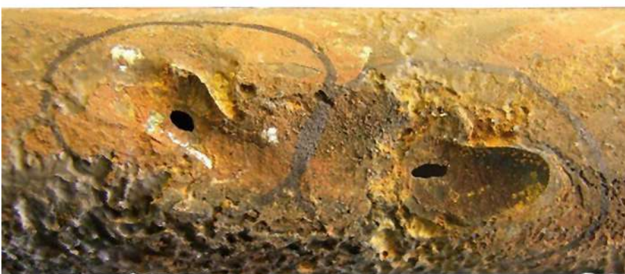
Abb. 8: Schadenbild Wasserstoffkorrosion an einem Stahlrohr, verursacht durch Schwefelsäure
