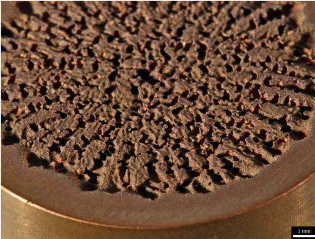
Abb. 22: Mittels Ultraschall-Sonotrode hervorgerufene Kavitationskorrosion an einer Versuchsplatte aus bleifreiem Rotguss
