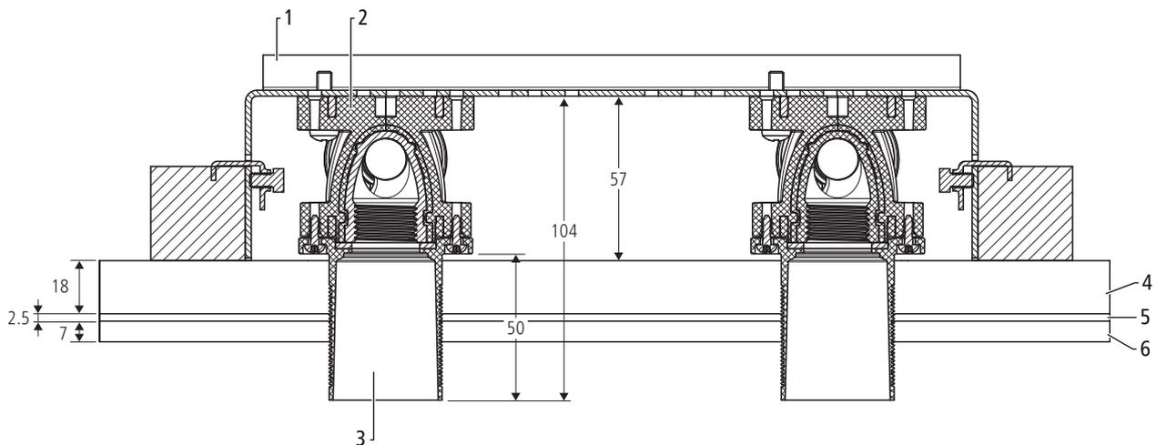
Abb. 11: Optiflex-GIS-Modul 1-fach beplankt 18 mm 85121/84221
