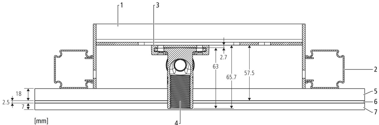
Abb. 6: Optivis-Tec-Armaturenräger-Modul 1-fach beplankt
