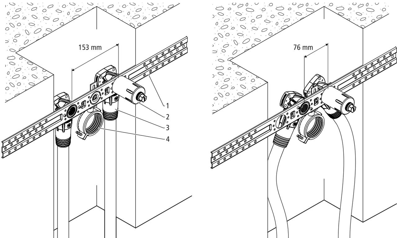
Abb. 1: Dosenabstände 153 und 76 mm mit der Montageschiene 85056
