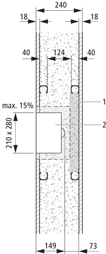
Abb. 26: Einbau auf einer Seite in Optivis-Tec-Trennwand 240 mm
