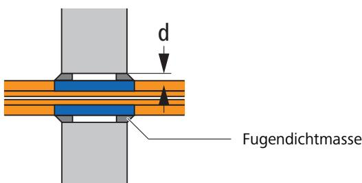
Abb. 39: Verschluss der brennbaren Wärmedämmschichten mit Baustoffen RF1
