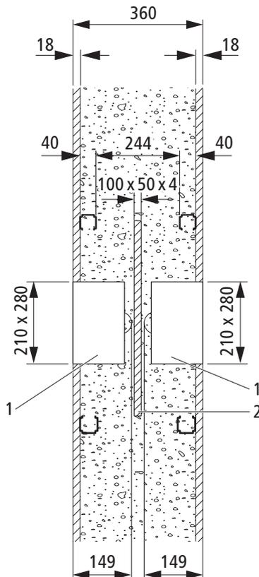
Abb. 27: Beidseitiger Einbau in Optimis-Tec-Trennwand 360 mm
