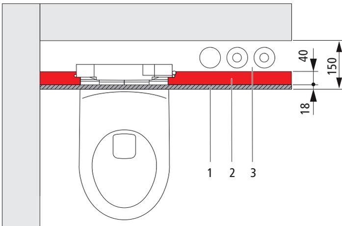
Abb. 22: Optivis-Tec-Vorwand 150 mm
