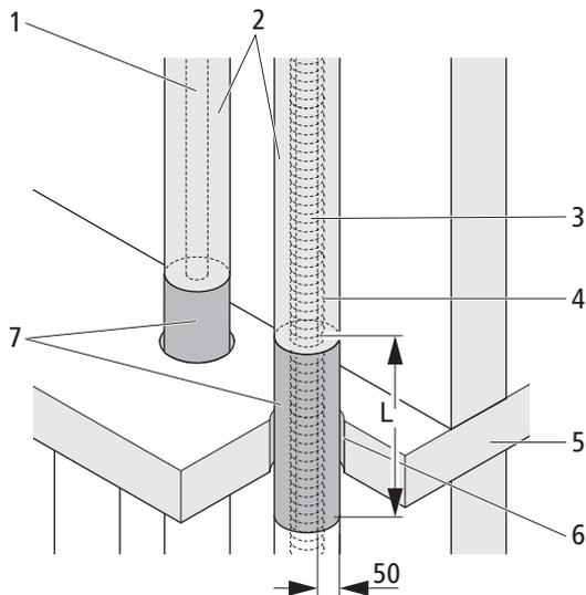
Abb. 36: Deckendurchführung mit RN Optiflex
