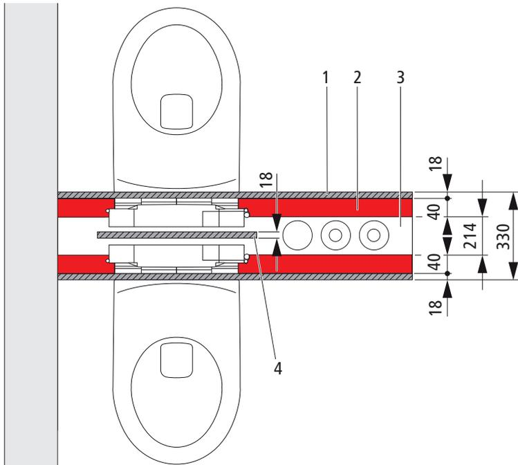
Abb. 20: Detailansicht Querschnitt Trennwand 330 mm
