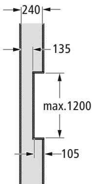
Abb. 14: Einseitig eingebaute Nische in Vorwand 240 mm
