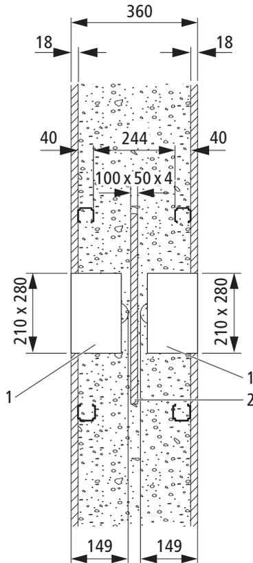
Abb. 11: Beidseitiger Einbau in Optimis-Tec-Trennwand 360 mm
