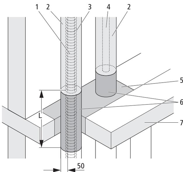
Abb. 35: Deckendurchführung mit RN Optiflex
