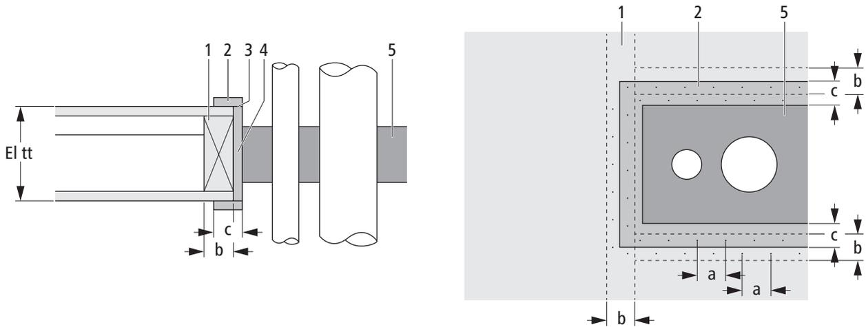
Abb. 16: Optimis-Tec-Installatio in Holzbau mit Kragen RF1
