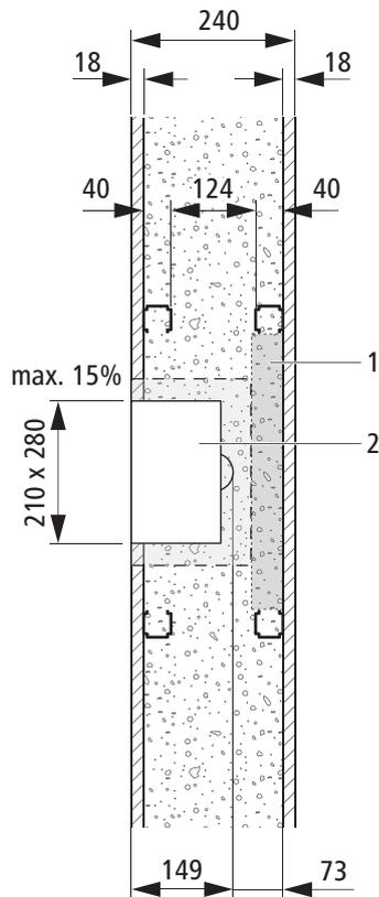
Abb. 10: Einbau auf einer Seite in Optivis-Tec-Trennwand 240 mm
