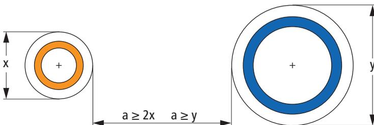
Abb. 42: Mindestabstand  $a$  bei Leitungen aus verschiedenen Baustoffen
