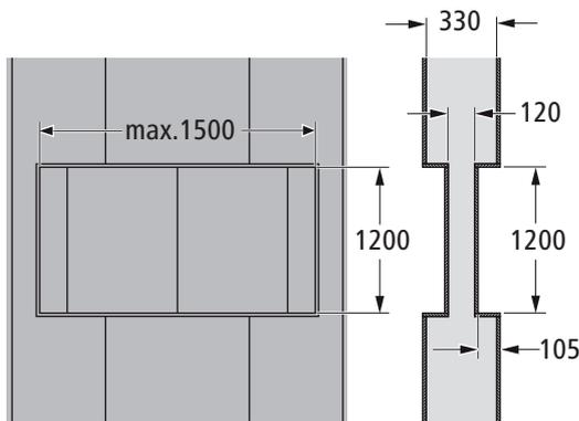
Abb. 13: Beidseitig eingebaute Nischen in Trennwand 330 mm
