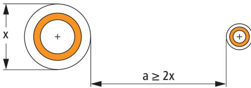
Abb. 41: Mindestabstand  $a$  bei unterschiedlich grossen Ausschnitten
