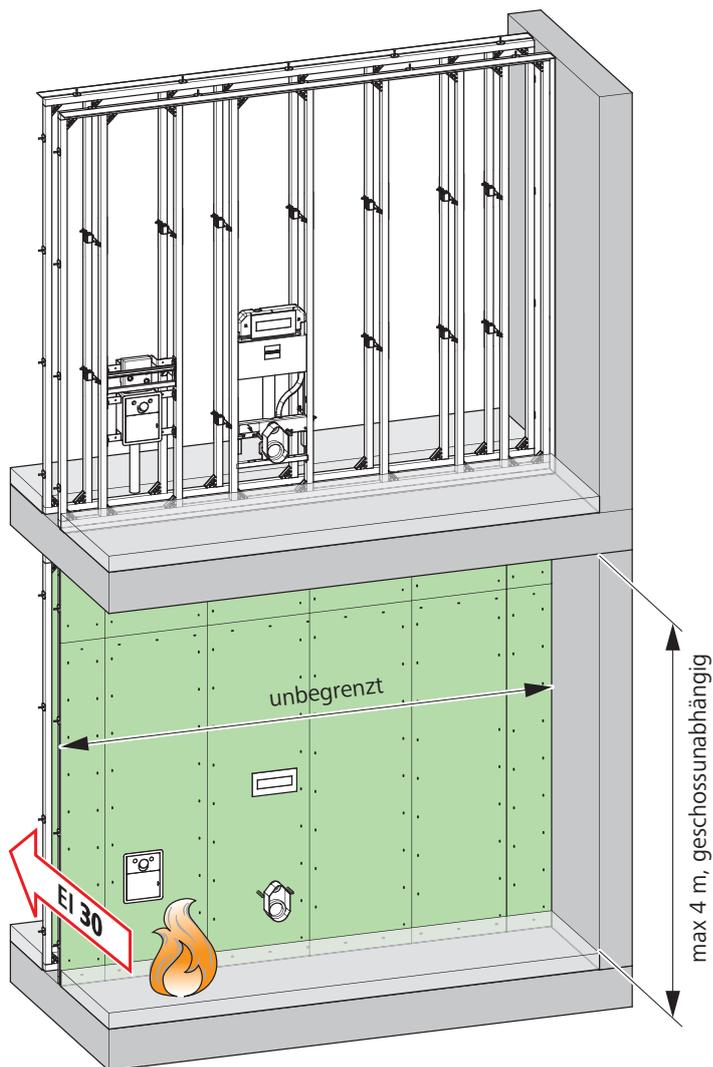
Die Optivis-Tec-Trennwände ohne Ausflockung wurden beim Schweizerischen Institut für Prüfung | Inspektion | Zertifizierung (SIPIZ) einer Feuerwiderstandsprüfung nach EN 1363-1 und EN 1364-1 unterzogen und erreichten einen Feuerwiderstand EI 30.
