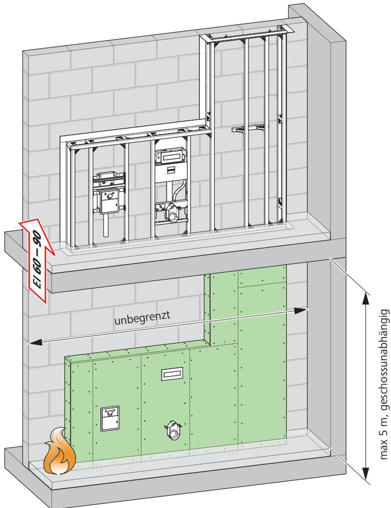
Die Optivis-Tec-Vorwände wurden beim Schweizerischen Institut für Prüfung | Inspektion | Zertifizierung (SIPIZ) einer Feuerwiderstandsprüfung nach EN 1363-1 und EN 1364-1 unterzogen und erreichten einen Feuerwiderstand EI 60 bzw. EI 90.
