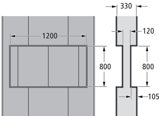
Abb. 29: Beidseitig eingebaute Nischen in Trennwand 330 mm
