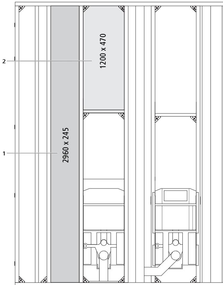
Abb. 24: Maximale leere Feldgrößen abhängig vom vertikalen Mittenabstand
