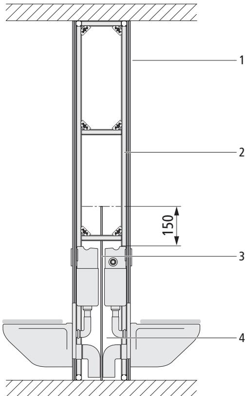
Abb. 21: Aufbau Optivis-Tec-Trennwand EI 90, D = 330 mm
