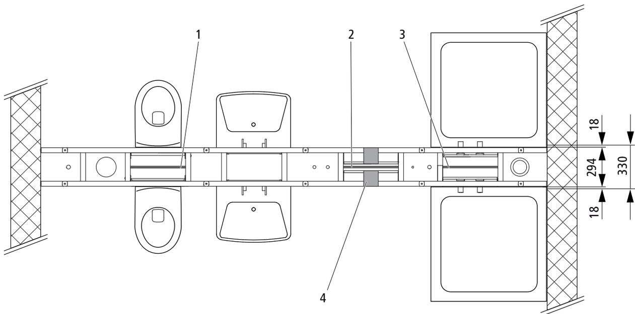
Abb. 19: Optivis-Tec-Trennwand 330 mm beidseitig belegt
