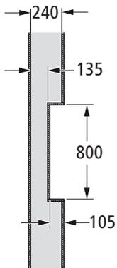
Abb. 30: Einseitig eingebaute Nische in Vorwand 240 mm
