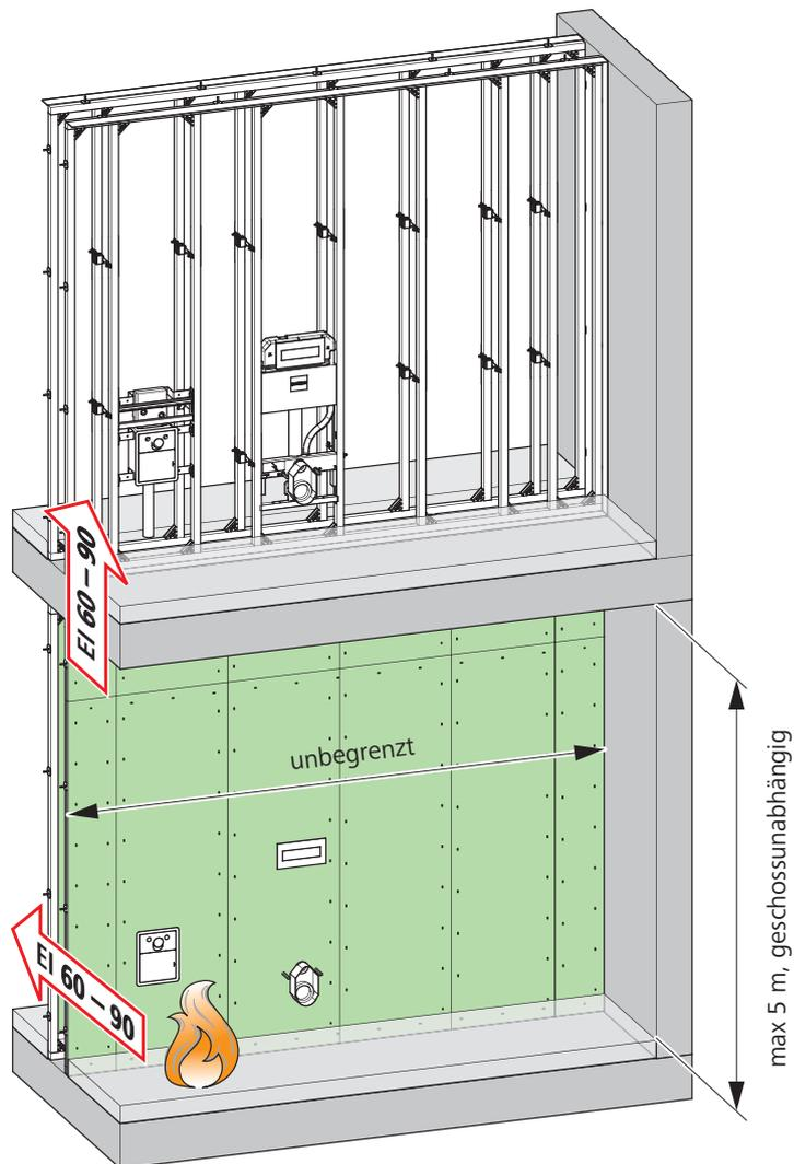
Die Optivis-Tec-Trennwände wurden beim Schweizerischen Institut für Prüfung | Inspektion | Zertifizierung (SIPIZ) einer Feuerwiderstandsprüfung nach EN 1363-1 und EN 1364-1 unterzogen und erreichten einen Feuerwiderstand EI 90.
