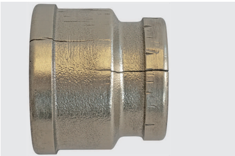
Fig. 19: Immagine del danno dovuto a tensocorrosione su un raccordo filettato.
