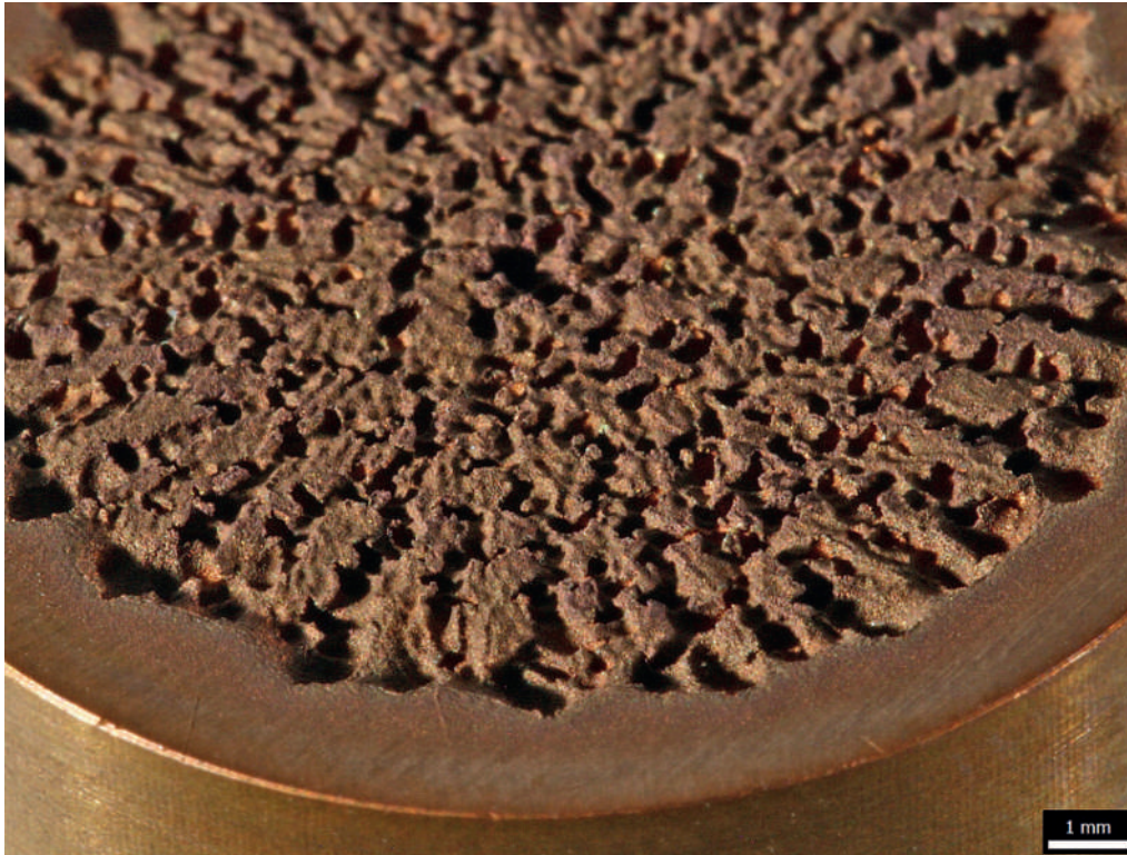
Fig. 22: Corrosione per cavitazione causata da un sonotrodo a ultrasuoni su una piastra di prova in bronzo privo di piombo.
