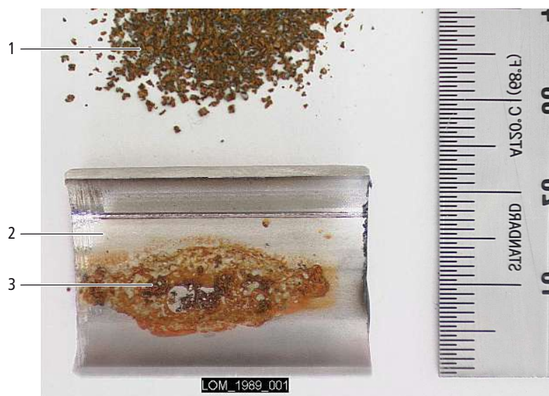
Fig. 45: Corrosione di trucioli metallici in un tubo in acciaio inossidabile.
