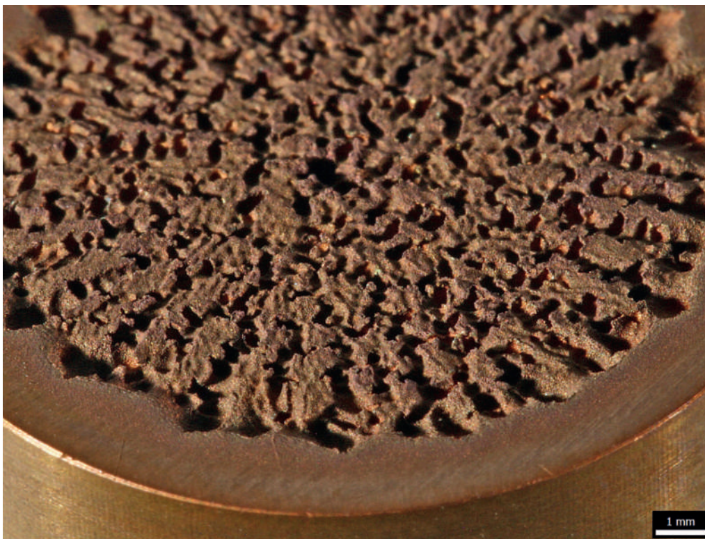
Fig. 22: Corrosione per cavitazione causata da un sonotrodo a ultrasuoni su una piastra di prova in bronzo privo di piombo.
