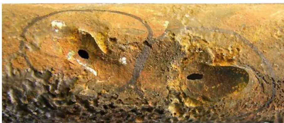
Fig. 8: Immagine del danno dovuto a corrosione da idrogeno su un tubo di acciaio causata da acido solforico.
