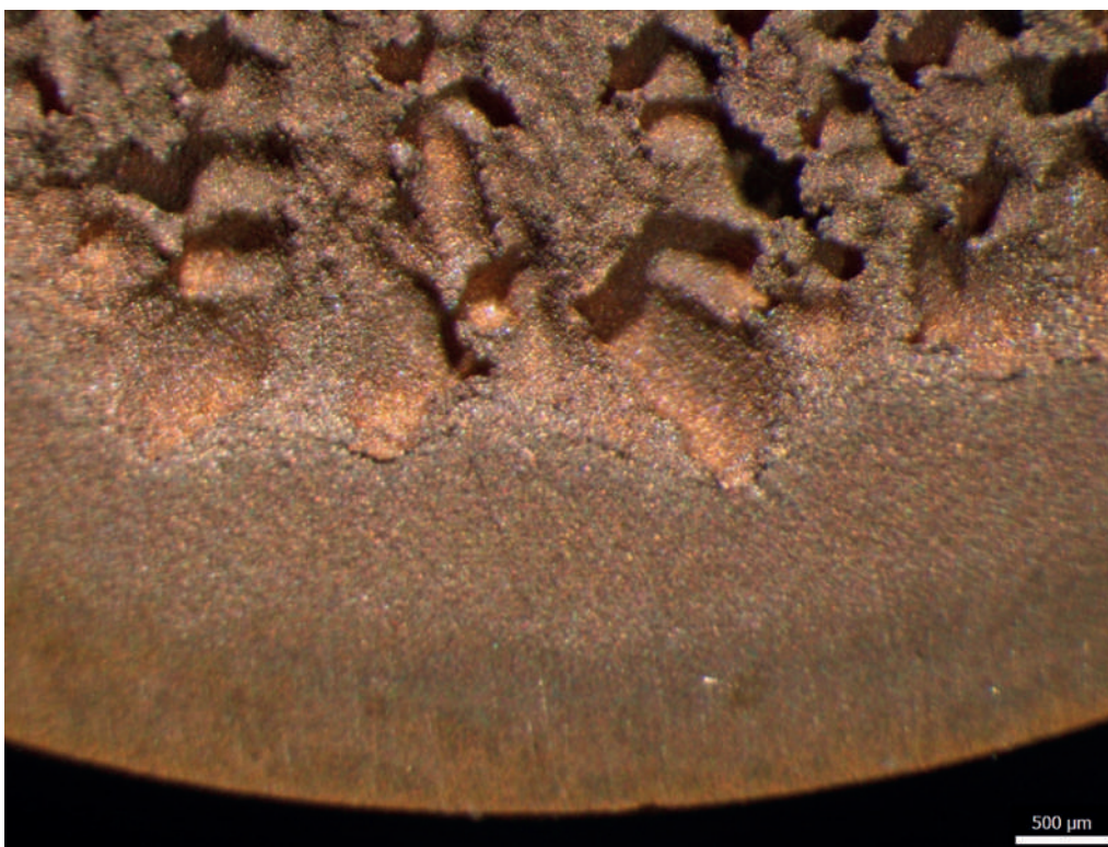
Fig. 23: Vista dettagliata dell'asportazione di materiale sulla piastra di prova.
