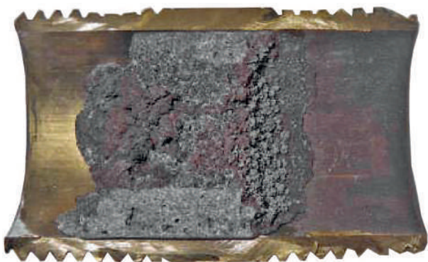
Fig. 38: Immagine del danno da depositi di calcare in fitting in ottone (immagine dal Promemoria suisse-tec W10019).
