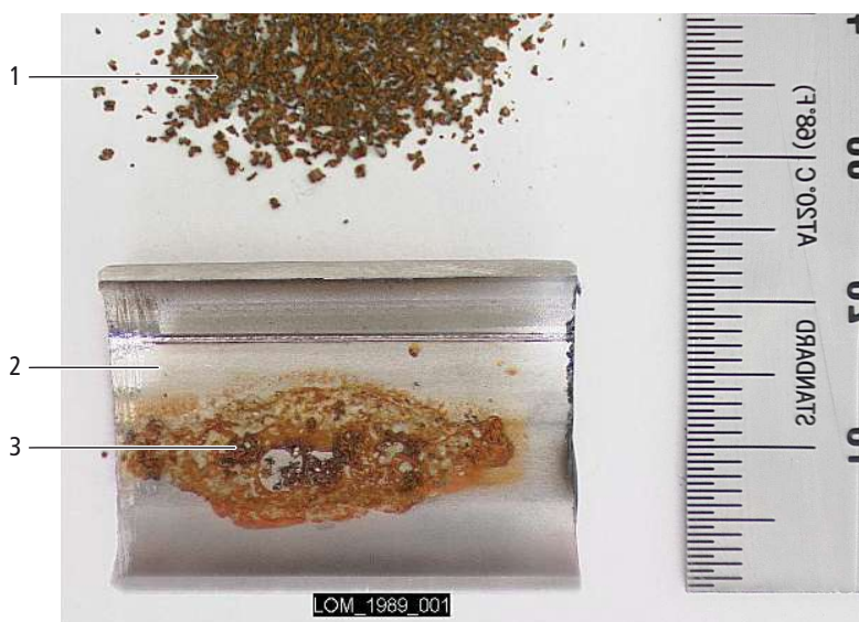
Fig. 45: Corrosione di trucioli metallici in un tubo in acciaio inossidabile.
