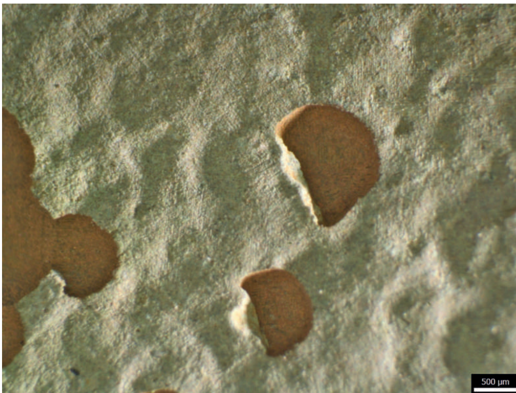
Fig. 21: Dettaglio dell'immagine del danno con avvallamenti a forma di ferro di cavallo caratteristici della corrosione da erosione.
