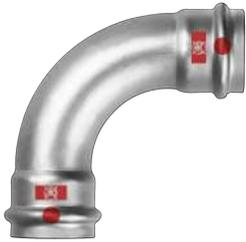
Pressfittings aus Stahl verzinkt sind aus unlegiertem Stahl mit der Werkstoffnummer 1.0308 (E235) hergestellt. Die Pressfittings sind innen und aussen galvanisch verzinkt. Sie sind gekennzeichnet mit dem Logo «kein Trinkwasser»:
