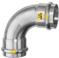
Die Edelstahl-Fittings sind aus hochlegiertem und rostbeständigem, austenitischem Cr-Ni-Mo-Stahl mit der Werkstoffnummer 1.4401 hergestellt.
