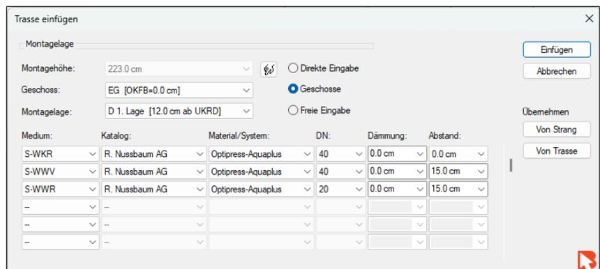
2. Im Dialogmenü [Trasse einfügen], die Eigenschaften von bereits gesetzten Strängen übernehmen oder neue Eigenschaften einfügen. Es können eingefügt werden Daten zu Montigelage, Dimensionen der Leitung, Medium, Dämmstärke, Achsabstand usw.
