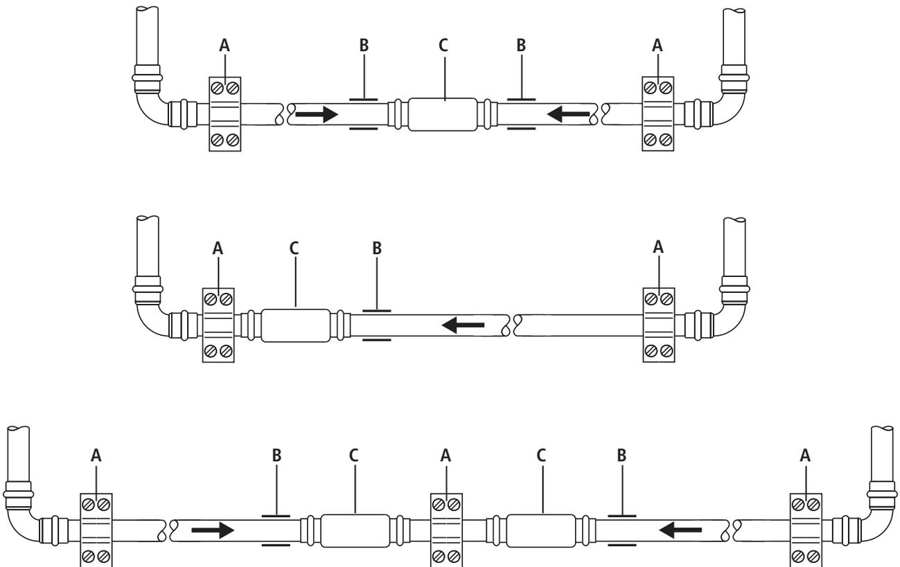
Fig. 1: Esempi di montaggio del compensatore longitudinale
