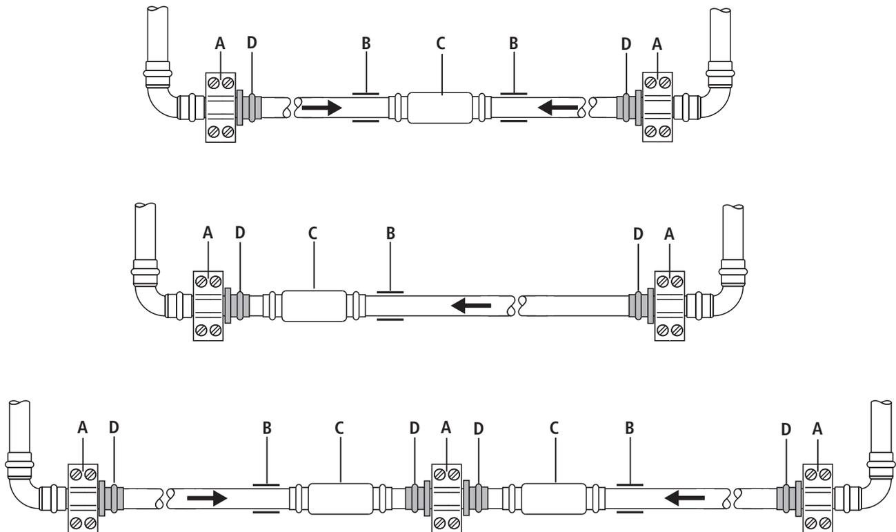
Fig. 2: Esempi di montaggio punto fisso Optipress-Aquaplus
