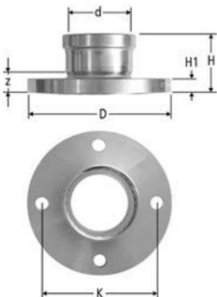
**55050****Optipress-Therm-Flanschübergang PN 6****Optipress-Therm-Bride PN 6****Optipress-Therm-Flangia PN 6**
