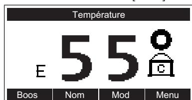
⇒ Le mode de fonctionnement auxiliaire [Boost] est réglé. Sur l'affichage de fonctionnement apparaît le symbole correspondant, «Affichage de fonctionnement», page 6.
