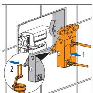
17. Die Betätigungsmechanik einsetzen und den Bügel an der Spülgarnitur einhängen.
