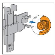
10. Das Füllventil in den Füllventilhalter einstecken, bis es spürbar einrastet.
