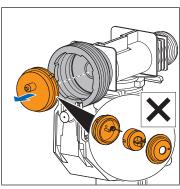
7. Das Membranventil demontieren. Dabei die Bauteile des Membranventils nicht auseinandernehmen, um Beschädigungen zu vermeiden.
