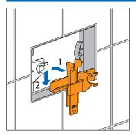
8. Den beiliegenden Füllventilhalter in die Führung an der Spülkastenrückwand einsetzen.
