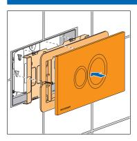
19. Die ggf. vorhandene Grundplatte, den Grundrahmen und die Betätigungsplatte montieren.
