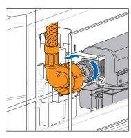
13. Den Panzerschlauch an das Füllventil ansetzen und handfest anschrauben. Dabei auf den richtigen Sitz des Panzerschlauchs am Füllventil achten.
