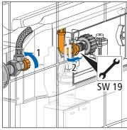
4. Das Eckventil schliessen und den Panzerschlauch (SW19) am Füllventil lösen.
