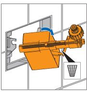
5. Das Füllventil im Spülkasten so drehen, dass es durch die Revisionsöffnung passt, aus dem Spülkasten herausnehmen und entsorgen.
