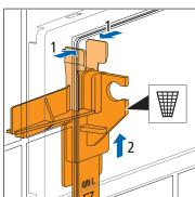
7. Die Flügel des Füllventilhalters zusammendrücken und den Füllventilhalter nach oben in der Führung aus dem Spülkasten herausnehmen und entsorgen.
