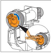
5. Den Befestigungskranz mit Hilfe einer Spitzzange durch eine 45°-Drehung gegen den Uhrzeigersinn lösen.
