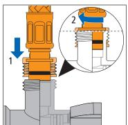
12. Den Überwurf des Panzerschlauchs handfest am Eckventil anschrauben. Darauf achten, dass der Panzerschlauch gerade auf dem Eckventil aufsitzt.
