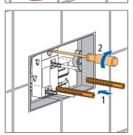
18. Den Spülkasten-Gewindebolzen-Satz montieren, um die Betätigungsmechanik im Spülkasten zu fixieren.
