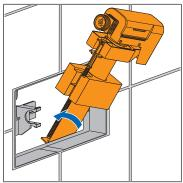
9. Das Füllventil in den Spülkasten einführen.
