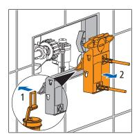
3. Den Bügel von der Spülgarnitur lösen und die Betätigungsmechanik nach vorne aus dem Spülkasten herausnehmen.
