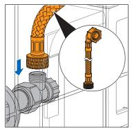
11. Den Panzerschlauch am Eckventil montieren.
