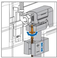
16. Wenn die Füllstandshöhe zu niedrig oder zu hoch ist, den Füllstand der Spindel nach justieren. Dazu den Schwimmer nach oben verstellen, um die Füllstandshöhe zu erhöhen und nach unten verstellen, um die Füllstandshöhe zu reduzieren.
