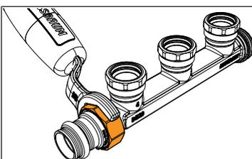
4. Die Überwurfmutter mit dem Ringschlüssel bis zum Anschlag festziehen. Der rote O-Ring darf nicht mehr sichtbar sein.
