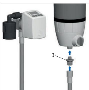
2. Den Panzerschlauch mit dem Übergang (3) an den Feinfilter anschliessen.
