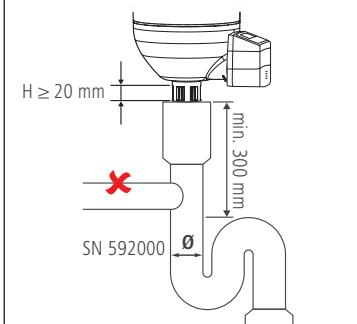
1. Eine Steckmuffe am Ablaufstutzen montieren oder einen Trichter an der Abflussleitung montieren.
