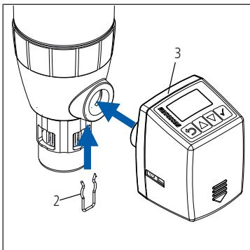
2. Die Rückspülautomatik (3) auf die Halterung stecken und mit der Klammer (2) sichern. Das Bedienfeld der Rückspülautomatik muss nach oben zeigen.
