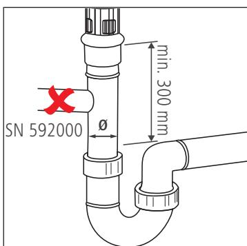
1. Die Steckmuffe am Ablaufstutzen montieren.
