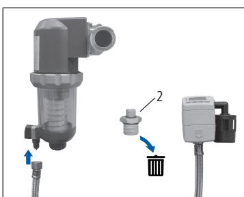
2. Den Panzerschlauch direkt an den Feinfilter anschliessen. Der mitgelieferte Übergang (2) kann entsorgt werden, er wird bei älteren Feinfiltern nicht benötigt.
