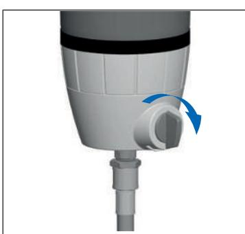
3. Den Kugelhahn des Feinfilters öffnen.
