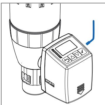
3. Das Kabel in den Stromanschluss (230 V) einstecken. Bei reinem Batteriebetrieb sicherstellen, dass die Batterien regelmässig geprüft und gewechselt werden.
