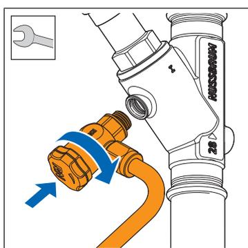
2. Das Probenahmeventil einschrauben. Bei Armaturen mit Entleeröffnung ⅜" den mitgelieferten Adapter einsetzen.
