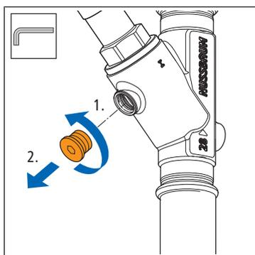
1. Den Verschlusszapfen an der Entleeröffnung der Armatur mit einem Sechskantschlüssel herausdrehen (SW 5 für ¼" oder SW 6 für ⅜").
