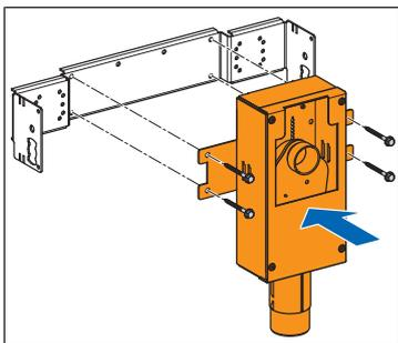
1. Den Geberit Wandeinbaukasten 243.722.00.1 mit den 4 beiliegenden Blechschrauben an der Montageschiene des Optimis-Tec-Waschtisch-Moduls befestigen.
