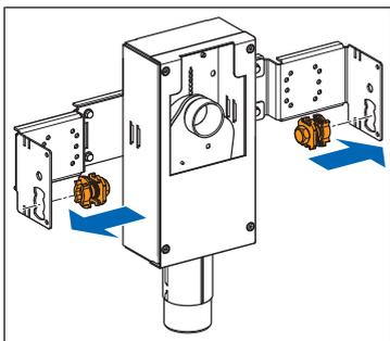
2. Die Montageschiene mit 2 Optimis-Nutensteinen 72004 an den Optimis-Tec-Schienen 71040 befestigen.
