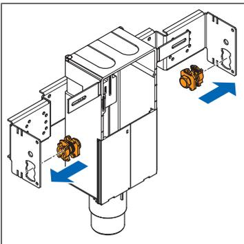
2. Die Montageschiene mit 2 Optivis-Nutensteinen 72004 an den Optivis-Tec-Schienen 71040 befestigen.
