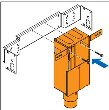
1. Den Geberit Wandeinbaukasten 151.125.00.1 mit den 2 beiliegenden Linsenschrauben (gewindefurchend) M6 × 12 mm an der Montageschiene des Optivis-Tec-Waschtisch-Moduls befestigen.
