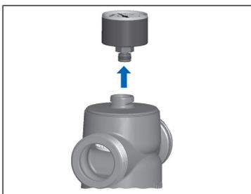
3. Das Manometer aus dem Druckreduzierventil herausziehen.
