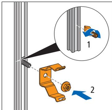
1. Den Drehrastbolzen (Geberit) in die GIS-Schiene stecken und die Halteklammer mit der Mutter daran festschrauben.
