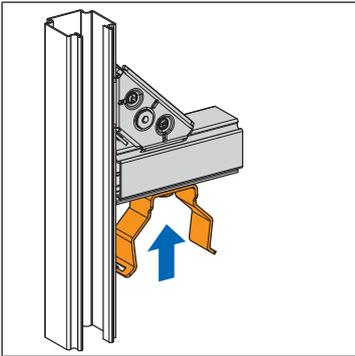
2. Die Dämmbox in die Halteklammer schieben.
