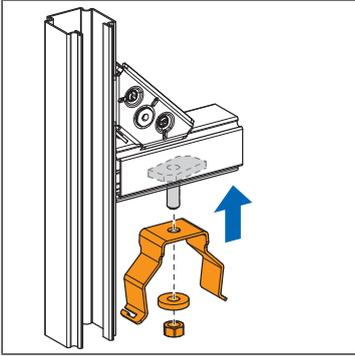
1. Die Halteklammer mit dem Befestigungsmaterial am Nutenstein 72039 in der Optivis-Tec-Schiene 71040 befestigen.
