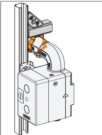
⇒ Das Befestigungs-Set 86200 ist montiert.
