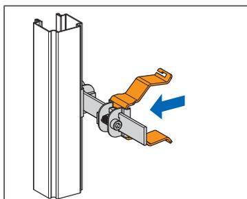
2. Die Dämmbox in die Halteklammer schieben.
