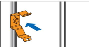
2. Die Dämmbox in die Halteklammer schieben.
