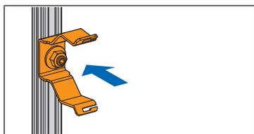
2. Die Dämmbox in die Halteklammer schieben.
