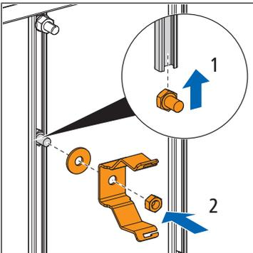
1. Die Halteklammer mit dem mitgelieferten Befestigungsmaterial an der Halteschiene des Verteilerkastens befestigen.
