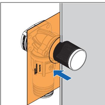
2. Die Optiflex-Dose einmauern und danach die Wandmanschette 86060 über die Abdichtungsverlängerung schieben.
