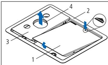
1. Auf die Markierung des Deckels **(1)** drücken und den Deckel aus dem Grundrahmen **(2)** entfernen.
