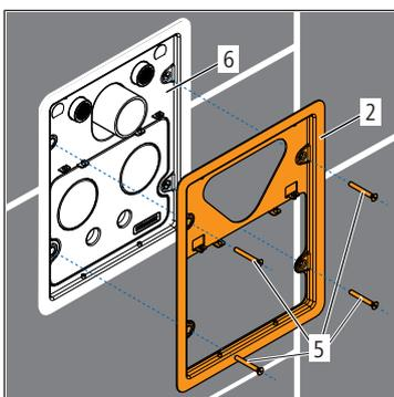
3. Den Grundrahmen **(2)** mit den mitgelieferten M5-Schrauben **(5)** an die verbaute Unterputz-Waschtischbox **(6)** schrauben. Die Schrauben handfest anziehen. Bei übermässiger Beanspruchung können die Gewindebolzen beschädigt werden.
