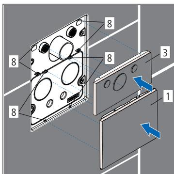
8. Den Deckel (1) und die Anschlussblende (3) auf die Lagerbolzen (8) stecken.
