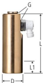
**55029****Optipress-Therm-Entlüftungsstopfen****Optipress-Therm-Purgeur d'air****Optipress-Therm-Tappo con valvola di sfiato**
