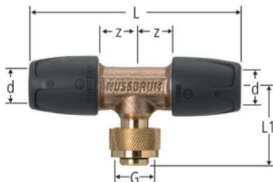
**85272****Optiflex-Profix-T-Stück**auf MF $\frac{1}{2}$ **Optiflex-Profix-Té**pour MF $\frac{1}{2}$ **Optiflex-Profix-Pezzo a Ti**per MF $\frac{1}{2}$
