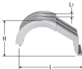
**87056****Optiflex-Rohrbrücke für 3 Rohrführungen**für Rohre  $\varnothing$  16 / 20**Optiflex-Rampe à 3 départs**pour tuyaux  $\varnothing$  16 / 20**Optiflex-Ponte di sostegno per 3 tubi**per tubi  $\varnothing$  16 / 20
