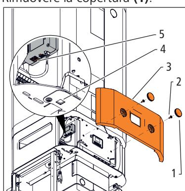
2. Far passare il cavo di rete attraverso l'apertura (2) e inserirlo nella presa RJ45 (3).
