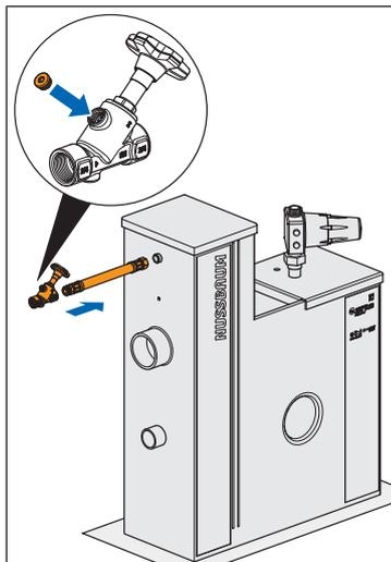
4. Collegare il tubo flessibile corazzato da 1" in alto e montare il pezzo a T ridotto Optifitt-Serra **(1)**.
