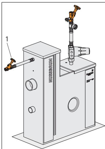
1. Aprire la valvola inclinata sul raccordo dell'acqua potabile **(1)**.
