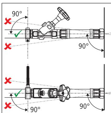
11. Fissare le condutture in modo tale da compensare eventuali oscillazioni. Evitare distanze di fissaggio eccessive.
