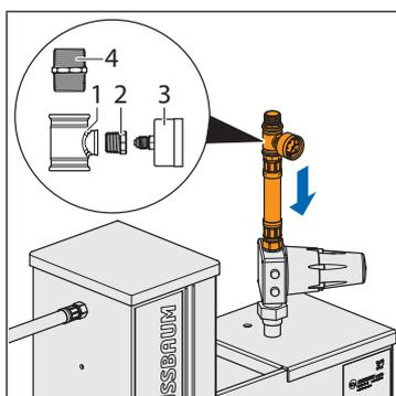
7. Montare la valvola KRV e avvitarsi la valvola di scarico.
