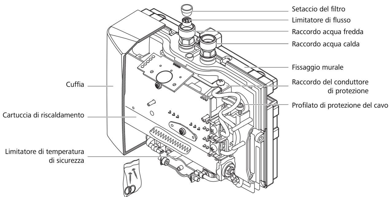
La targhetta si trova sulla cuffia tra il pannello di comando e i raccordi per l'acqua e contiene tutte le informazioni tecniche rilevanti, i dati dell'apparecchio e le demarcazioni colorate per afflusso (blu) e scarico (rosso) dell'acqua.
