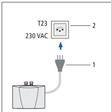
1. Inserire la spina di alimentazione **(1)** del cavo di collegamento in una presa di rete T23 **(2)**. Il conduttore di protezione deve essere collegato.
