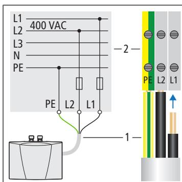
1. Collegare il conduttore di protezione e i due conduttori esterni del cavo di collegamento **(1)** ai morsetti di collegamento dell'impianto domestico **(2)**.
