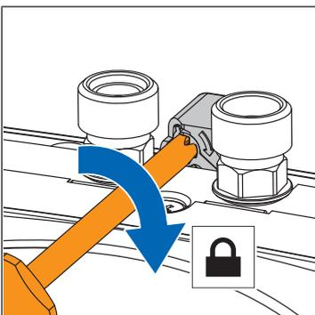
2. Bloccare l'apparecchio sul supporto a parete utilizzando un cacciavite a croce. L'apparecchio può essere messo in funzione unicamente se bloccato a regola d'arte sul supporto a parete.
