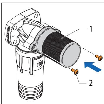
1. Posizionare la prolunga guarnizione (1) sulla scatola Optiflex e fissarla alla scatola utilizzando le viti a testa bombata (2) fornite in dotazione.
