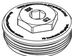
*Fig. 3: Tappo di chiusura in materiale sintetico*
