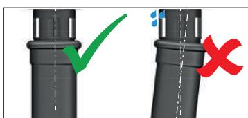
2. Collegare la conduttura di scarico senza esercitare pressione laterale sul bocchettone di scarico.
