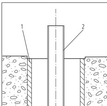
1. Annegare a filo nel cemento un tubo di guida in PE 50 x 44 (1) con un adatto tubo Optiflex PE-Xc inserito (2) 87133.21 oppure 87133.22.
