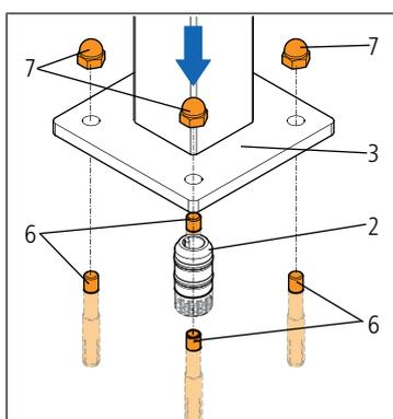
5. Inserire la rubinetteria di scarico **(3)** verticalmente sul nippel a innesto **(2)** e le viti di ancoraggio **(6)**, e avvitare al fondo con i dadi esagonali ciechi forniti **(7)**.
