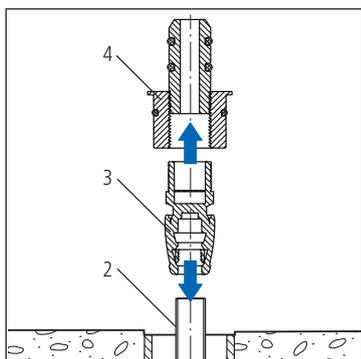
2. Avvolgere della canapa sulla filettatura del collegamento Optiflex-Profix (3) 85130.23 oppure 85130.24 e, utilizzando una chiave fissa, avvitare nel nippel a innesto (4) 45012.
