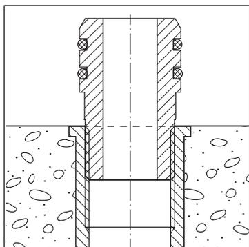
3. Pronto per il montaggio finito di realizzazioni speciali di rubinetteria di scarico.
