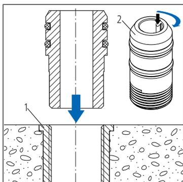
2. Avvolgere della canapa sulla filettatura del nippel a innesto (2) 45010 e avvitare con una chiave speciale (chiave a raccordo) sul manicotto (1).
