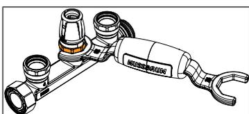
► Svitare il collegamento a innesto e il collegamento di sicurezza. Una volta inseriti il collegamento a innesto e il collegamento di sicurezza, non è più possibile separare i due pezzi.
