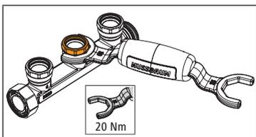
► Avvitare il collegamento di sicurezza sul distributore. Procedere senza superare la coppia di serraggio massima di 20 Nm.
