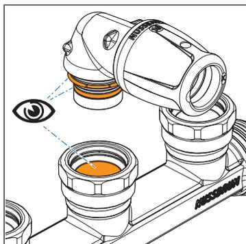
1. Effettuare un controllo visivo delle superfici, dell'O-ring e dell'anello a scatto. La superficie interna dell'uscita collettore deve essere pulita e priva di depositi.
