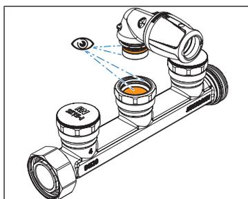
2. Effettuare un controllo visivo delle superfici e dell'O-ring. La superficie interna dell'uscita collettore deve essere pulita e priva di depositi.
