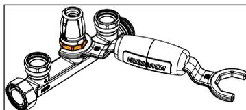
1. Svitare il collegamento a innesto e il collegamento di sicurezza.
