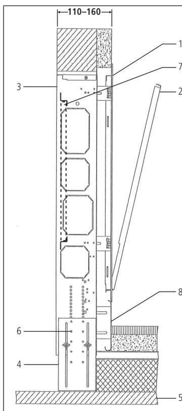
1. Per la cassetta di revisione 86044: Rimuovere il telaio **(1)** e la porta **(2)** dall'elemento di base **(3)**.
