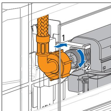
13. Placer le tuyau renforcé sur le robinet flotteur et le visser à la main. Vérifier que le tuyau renforcé est bien en place sur le robinet-flotteur.
