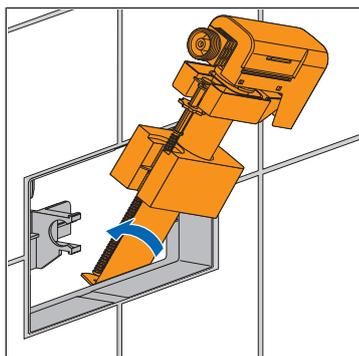
9. Introduire le robinet-flotteur dans le réservoir de chasse.
