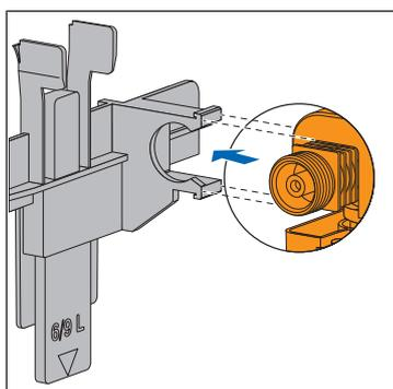
10. Insérer le robinet-flotteur dans le support de robinet-flotteur jusqu'à l'audition d'un clic.
