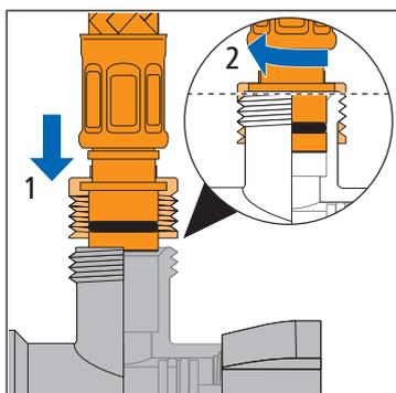
12. En utilisant la main, visser l'écrou mobile du tuyau renforcé sur le robinet équerre. Veiller à ce que le tuyau renforcé repose bien droit sur le robinet équerre.
