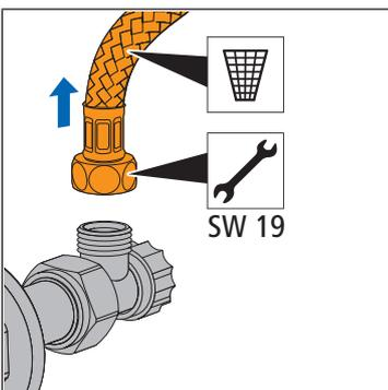
6. Dévisser le tuyau renforcé (SW 19) sur le robinet équerre, l'extraire de l'avant du réservoir de chasse et l'éliminer.
