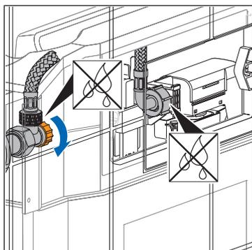
14. Ouvrir le robinet équerre et vérifier son étanchéité ainsi que l'étanchéité du raccord du robinet-flotteur.
