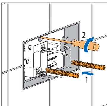
18. Mettre en place le set de tiges de fixation pour réservoir de chasse afin de fixer le mécanisme de commande dans le réservoir de chasse.
