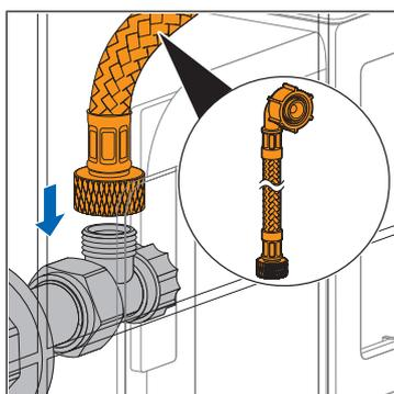
11. Placer le tuyau renforcé sur le robinet équerre.
