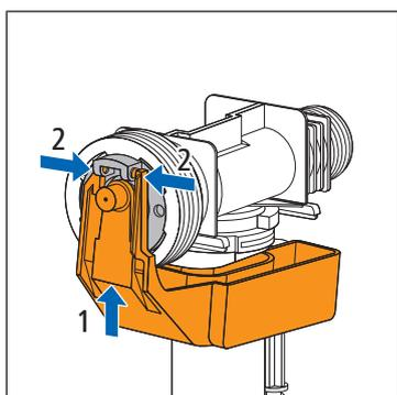
12. Remonter la suspension du flotteur sur la pièce de fermeture.
