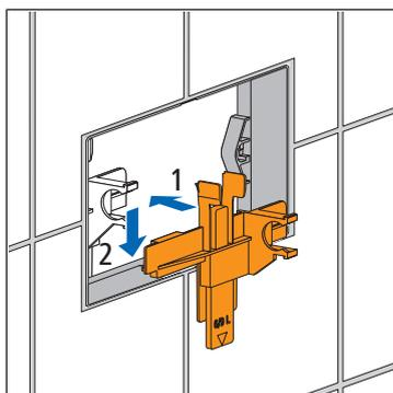
8. Prendre le support de robinet-flotteur fourni et le placer sur le guide de la paroi arrière du réservoir de chasse.
