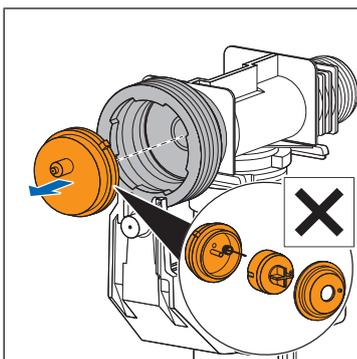
7. Enlever le robinet à membrane. Ce faisant, ne pas démonter les composants du robinet à membrane pour éviter tout dommage.
