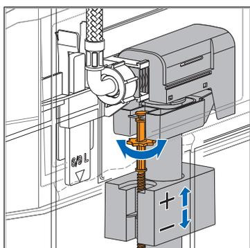
16. Si le niveau de remplissage est trop faible ou trop élevé, le régler au moyen de la tige. Pour ce faire, soit régler le flotteur vers le haut pour augmenter le niveau de remplissage, soit l'abaisser pour réduire le niveau de remplissage.
