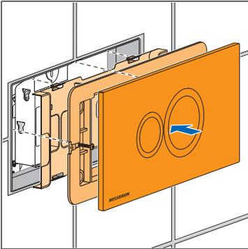
19. Monter la plaque de base s'il y en a une, le cadre de base et la plaque de commande.
