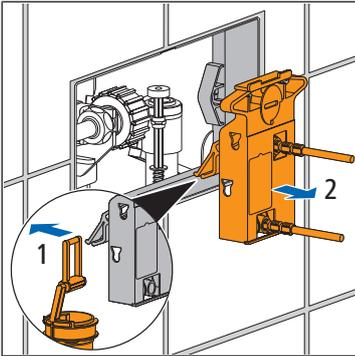
3. Détacher l'étrier de la cloche et extraire le mécanisme de commande de l'avant du réservoir de chasse.
