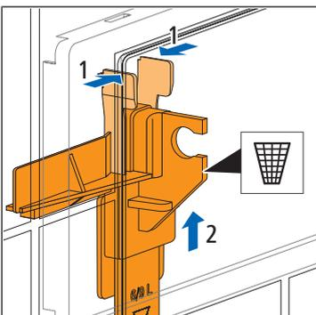
7. Pincez les ailes du support de robinet-flotteur et le tirer vers le haut sur le guide pour l'extraire du réservoir de chasse, puis l'éliminer.
