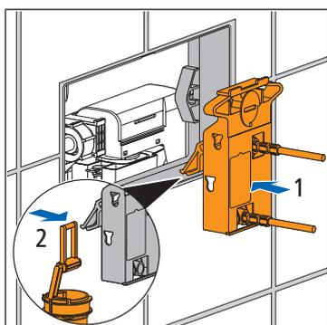
17. Mettre en place le mécanisme de commande et accrocher l'étrier à la cloche.
