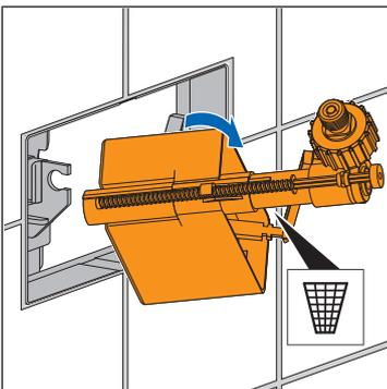
5. Tourner le robinet-flotteur dans le réservoir de chasse de manière à pouvoir l'extraire de la trappe de visite; l'enlever du réservoir de chasse et l'éliminer.
