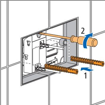
19. Mettre en place le set de tiges de fixation pour réservoir de chasse afin de fixer le mécanisme de commande dans le réservoir de chasse.
