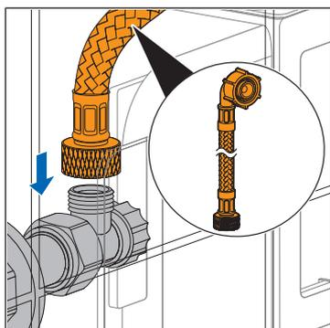
13. Placer le tuyau renforcé sur le robinet équerre.
