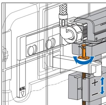
17. Vérifier le niveau de remplissage du réservoir de chasse. L'eau doit arriver jusqu'au repère de hauteur. Si le niveau de remplissage est trop faible ou trop élevé, le régler au moyen de la tige. Pour ce faire, soit régler le flotteur vers le haut pour augmenter le niveau de remplissage, soit l'abaisser pour réduire le niveau de remplissage.
