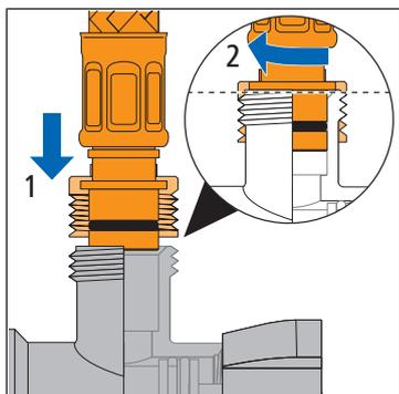
14. Visser à la main l'écrou mobile du tuyau renforcé sur le robinet équerre. Veiller à ce que le tuyau renforcé repose bien droit sur le robinet équerre.
