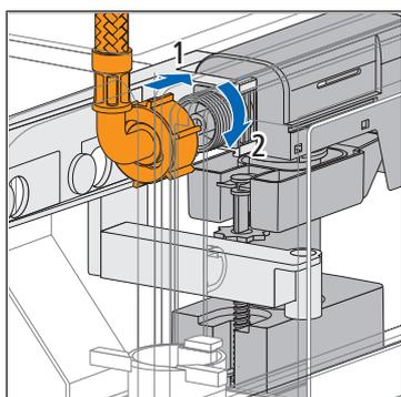
15. Placer le tuyau renforcé sur le robinet flotteur et le visser à la main. Vérifier que le tuyau renforcé est bien en place sur le robinet-flotteur.
