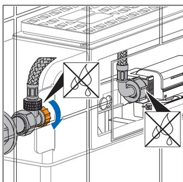
16. Ouvrir le robinet équerre et vérifier son étanchéité ainsi que l'étanchéité du raccord du robinet-flotteur.
