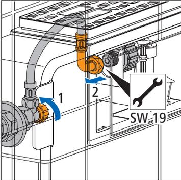
4. Fermer le robinet équerre, puis desserrer et retirer le tuyau renforcé (SW19) du robinet-flotteur.
