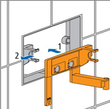
9. Placer le support de robinet-flotteur fourni sur le guide de la paroi arrière du réservoir de chasse et le faire glisser vers la droite jusqu'à entendre un clic.
