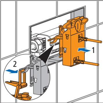
18. Mettre en place le mécanisme de commande et accrocher l'étrier à la cloche.
