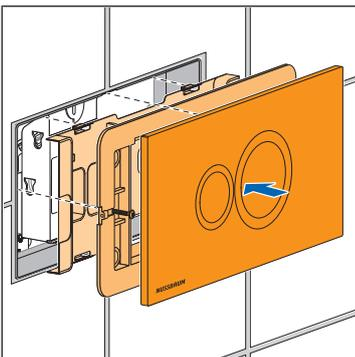
20. Monter la plaque de base s'il y en a une, le cadre de base et la plaque de commande.
