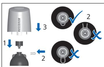
1. Mettre en place le manomètre. Veiller à le placer de manière à pouvoir lire facilement les valeurs mesurées. Une fois mis en place, le manomètre ne bouge plus.
