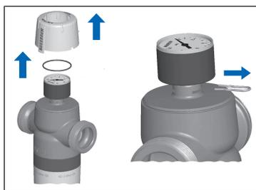
2. Enlever la cape de protection et le joint torique en tirant par le haut et extraire l'agrafe de montage par le côté.
