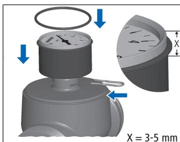
1. Mettre en place le manomètre, le fixer sur le côté avec l'agrafe de montage et apposer le joint torique. Veiller à ne pas placer le joint torique trop bas (3 à 5 mm sous le bord supérieur du manomètre), de manière à ce que la cape de protection ne bouge pas.
