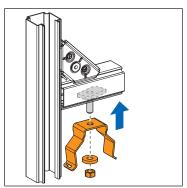
1. Fixer le clip de maintien avec le matériel de fixation sur le set d'ancrage 72039 dans le profilé Optivis-Tec 71040.
