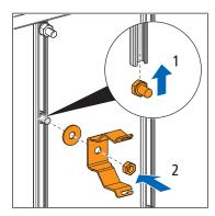
1. Utiliser le matériel de fixation fourni pour fixer le clip de maintien sur le rail de fixation du coffret à encastrer.
