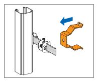
1. Serrer le clip de maintien dans la pince de la pièce d'assemblage parallèle Optivis-Tec 71043.21.
