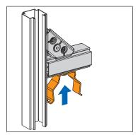
2. Insérer la coque isolante dans le clip de maintien.
