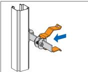
2. Insérer la coque isolante dans le clip de maintien.
