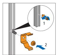
1. Insérer le connecteur à verrouillage pivotant dans le rail GIS et y attacher le clip de maintien en vissant l'écrou.
