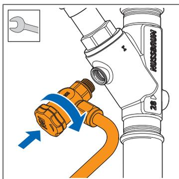
2. Monter le robinet pour prise d'échantillon. Pour les robinetteries à ouverture de purge 3/8", monter l'adaptateur fourni.
