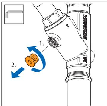
1. Tourner le bouchon de fermeture sur l'ouverture de purge du robinet en utilisant une clé à six pans (SW 5 pour 1/4" ou SW 6 pour 3/8").
