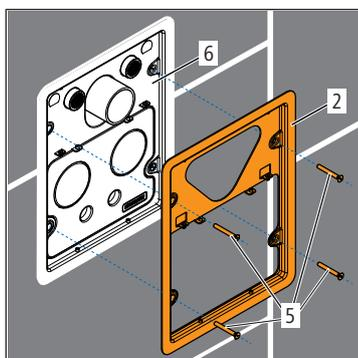
3. Visser le cadre de base **(2)** avec les vis M5 incluses **(5)** sur le boîtier lavabo à montage caché en place **(6)**. Serrer les vis à la main. En cas de sollicitation excessive, les tiges de fixation peuvent être endommagées.
