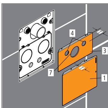
5. Pour le couvercle (1), couper le carreau de carrelage à la dimension 160 x 200 mm et pour le cache (3), couper le carreau de carrelage à la dimension 104 x 200 mm. Tenir compte de la dimension maximale de recouvrement (T) (20 mm).
