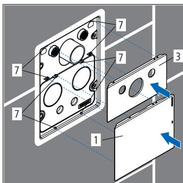
4. Replacer le couvercle (1) et le cache (3) sur les tiges (7).
