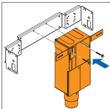
1. En s'aidant des 2 vis à tête bombée (autotaraudeuses) M6 × 12 mm fournies, fixer le caisson mural encastrable Geberit 151.125.00.1 sur le gabarit de montage du module lavabo Optivis-Tec.
