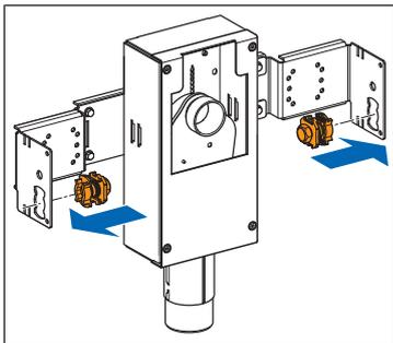
2. Fixer le gabarit de montage avec 2 sets d'ancrage Optivis 72004 sur les profilés Optivis-Tec 71040.
