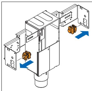
2. Fixer le gabarit de montage avec 2 sets d'ancrage Optivis 72004 sur les profilés Optivis-Tec 71040.
