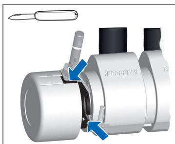
3. En cas de besoin, utiliser un couteau pour réaliser des traversées pour les tiges filetées de fixations de tuyaux ou de distributeurs.
